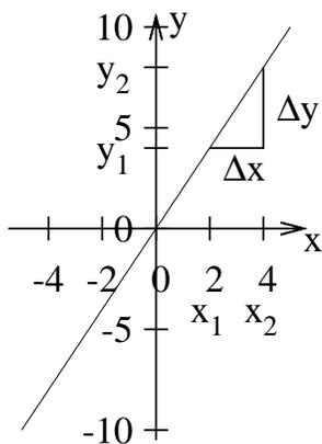
Abbildung 1.1: Eine Gerade und ein Steigungsdreieck. Die Seite nach oben heißt  $\Delta y$  und die Seite des Dreiecks parallel zur x-Achse heißt  $\Delta x$ .
