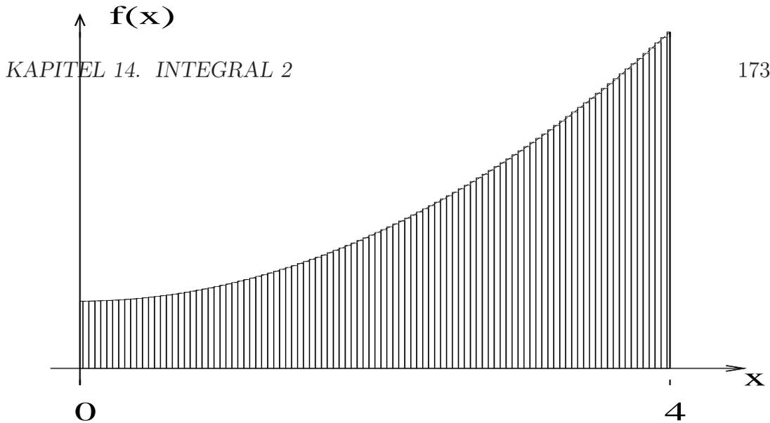
Abbildung 14.10: Der Fehler bei der Berechnung der Fläche wird bei kleinerer Breite der Rechtecke immer kleiner. Die Funktion wurde stark vergrößert, um den Effekt besser sehen zu können.
