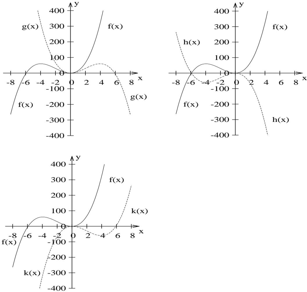
Abbildung 17.3: Jeweils Originalfunktion mit an der y-Achse gespiegelter Funktion, an der x-Achse gespiegelter Funktion und punktgespiegelter Funktion.
