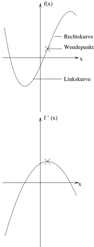
Abbildung 5.2: In den beiden Abb. sehen Sie eine Funktion und ihre Ableitung. Der Wendepunkt kennzeichnet den Punkt, wo die Linkskurve in eine Rechtskurve übergeht, bzw. die Steigung maximal ist.
