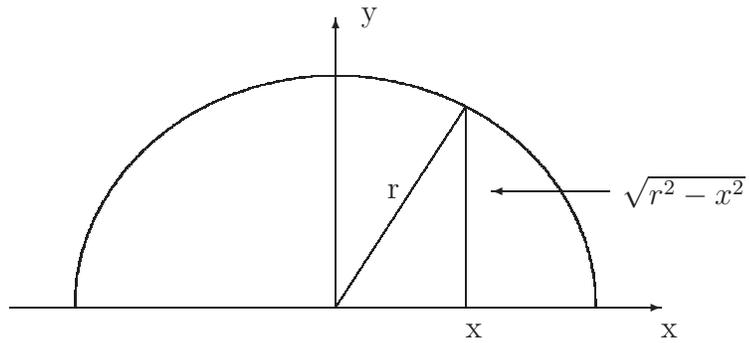
Abbildung 14.24: Die Fläche eines Halbkreises kann als die Fläche unter dem Graphen von  $f$  betrachtet werden mit  $f(x) = \sqrt{r^2 - x^2}$ .
