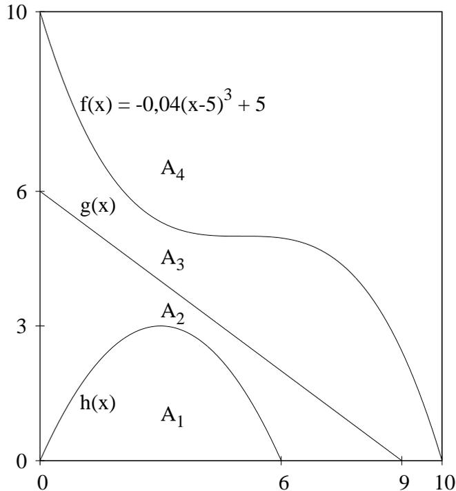
Abbildung 14.17: Ein Blech ist durch ein CAD-Programm in 4 Teilflächen zerschnitten:  $A_1$  bis  $A_4$ .  $g(x)$  ist eine lineare Funktion und  $h(x)$  ist eine quadratische Funktion.
