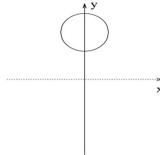
Abbildung 14.27: Ein Torus ist hier ein um die x-Achse rotierender Kreis.
